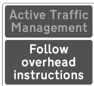
Рис. 2. Великобритания. Дорожный знак «Активное управление движением. Следуйте инструкциям» Под активным управлением понимается совместное использование временных ограничений скорости, разрешения движения по обочинам и светофорного регулирования на рампях развязок
